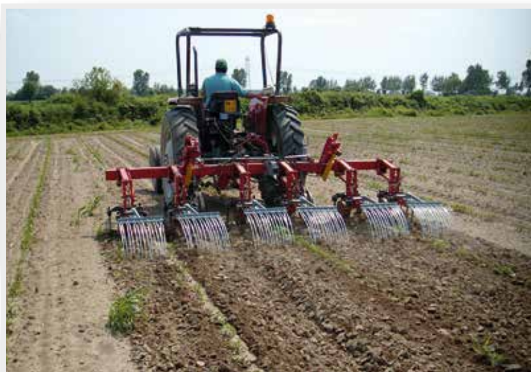
Sarchiatrice per pomodori a tre file con guida e chiusura idraulica stradale Cultivator for 3 rows of tomatoes with hydraulic folding frame
