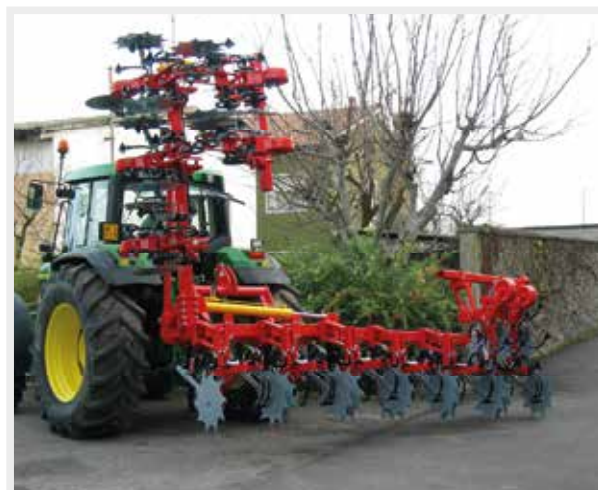
Sarchiatrice per la lavorazione del mais 12 file richiudibile idraulicamente in 3 metri di ingombro Inter-row cultivator with hydraulic folding frame
