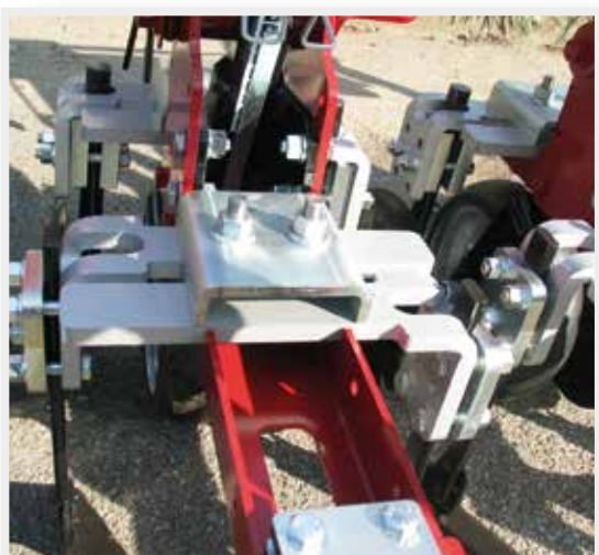
Regolazione Millimetrica della grandezza di lavoro / Millimetric regulation of working depth
