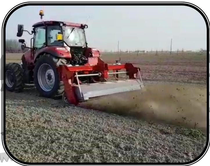
La macchina permette attraverso un rullo metallico dotato di punte intercambiabili ad alta resistenza, di spazzolare il terreno di pochi centimetri con l'aggressività superficiale necessaria a sradicare l'infestante, anche quando si trova in fase di crescita piuttosto importante, senza rallentare la velocità di lavoro del trattore.
