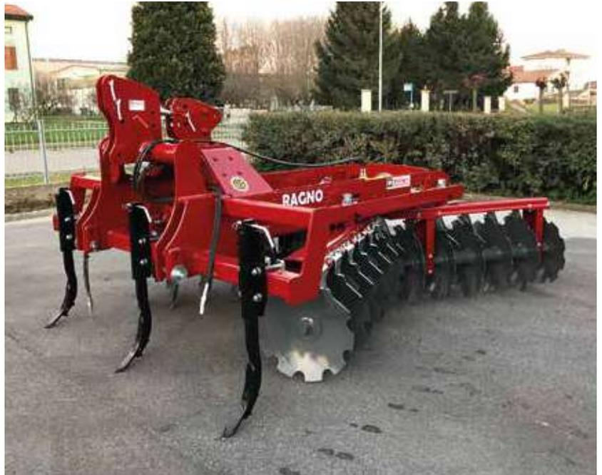
Un ingrassatore permette la periodica ricarica di grasso lubrificante. I dischi sono costruiti in acciaio legato, di nuova concezione, per resistere all'usura ed agli urti. I distanziali sono composti da flange in acciaio stampato antiurto. I raschiatori netta dischi sono regolabili singolarmente per recuperare il gioco dovuto all'usura. Disponibili 3 modelli, tutti con dischi diametro 61: con 16 dischi, con 20 dischi e con 24 dischi. Adatto a trattori da 100 a 200 CV.
